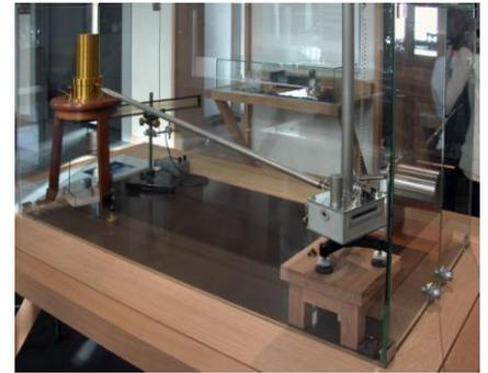
Parmi les instruments très importants, il y a la chambre à brouillard inventée en 1897-1899. Elle permet de visualiser et de photographier les trajectoires de particules ionisantes par un éclairage latéral lors de la détente d'un gaz saturé en humidité. Irène et Frédéric Joliot-Curie effectueront de nombreuses recherches scientifiques (sur le neutron, l'électron positif, la radioactivité artificielle, la fission de l'uranium...) avec cet instrument.
